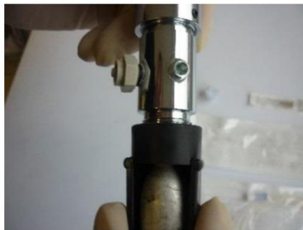
2. Podłączyć mini regulator ciśnienia poprzez wkręcenie go do osadki na pojemniku z CO 2 .
